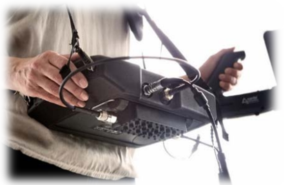
Bild 10: Externe Filter zwischen Antenne und Empfänger
