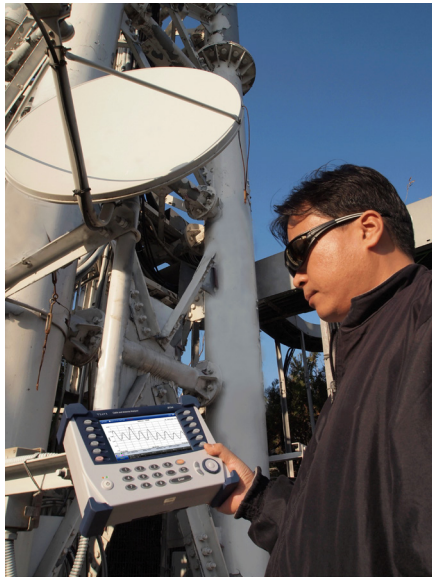
Der Tageslicht-Anzeigemodus erleichtert das Ablesen bei direkter Sonneneinstrahlung
