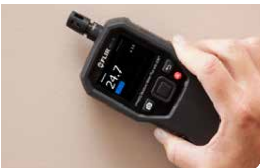
Feuchtigkeit mit nicht-invasiven Messungen überprüfen
