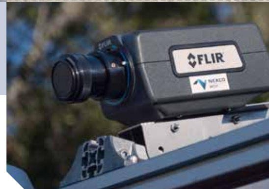
FLIR A6701sc-Kamera für die Erstellung von Infrarotkarten von Delaminationen
