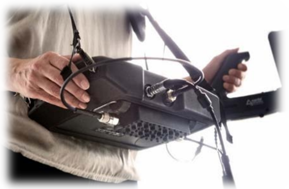
Bild 10: Externe Filter zwischen Antenne und Empfänger
