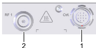
Figure 5: HF-Kabel anschließen: Steueranschluss (1) und N-Anschluss (2)
